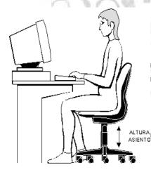
Se acciona mediante una palanca que suele estar colocada debajo del asiento, normalmente a la derecha.
