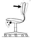
Es un mecanismo que permite liberar el respaldo, de manera que éste se mueve acompañando a los movimientos de la espalda del usuario.
